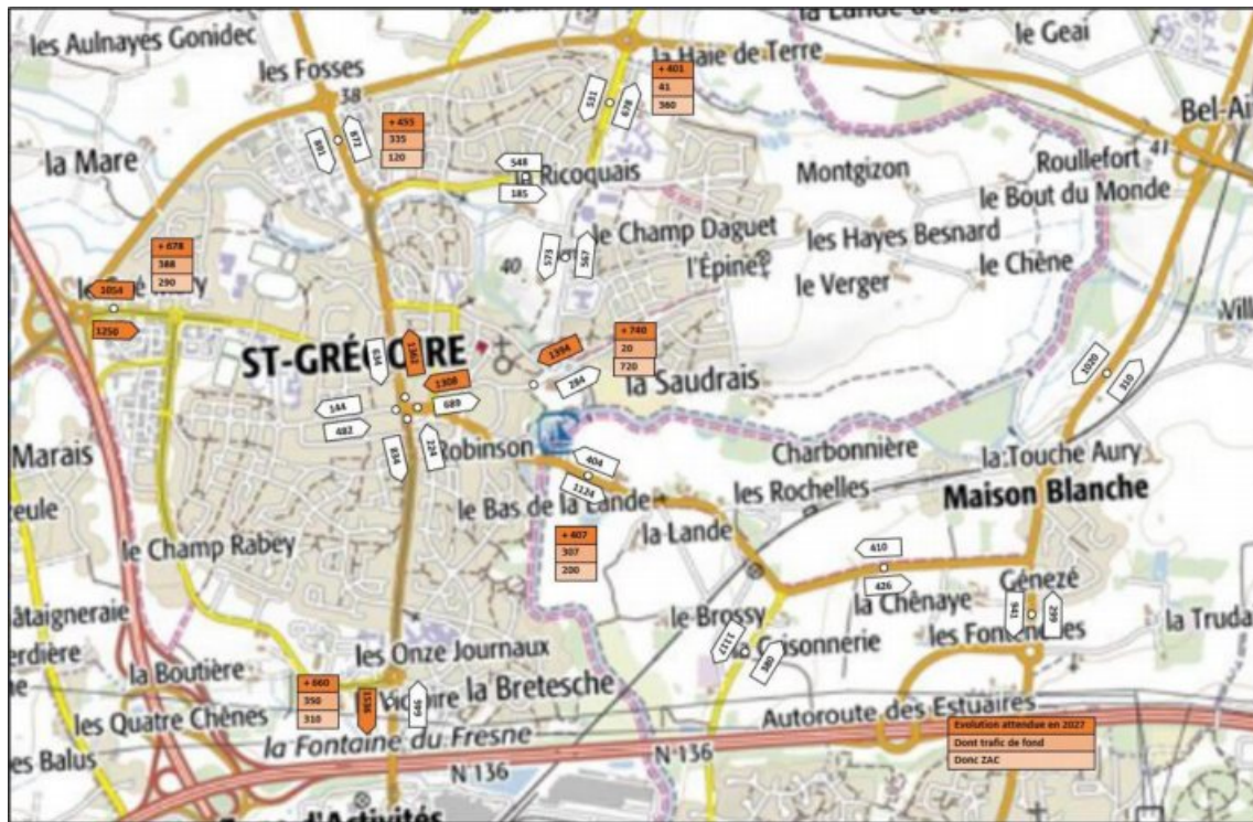
Figure 11 : Modélisation du trafic en 2027 sans le pont en heure de pointe (orange : saturation)
